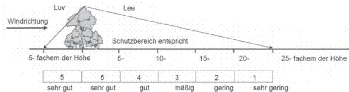
Abbildung 2: Stufen der Schutzwirkung und Einteilung von Schutzbereichen vor und hinter Windhindernissen (nach DIN 19076)
