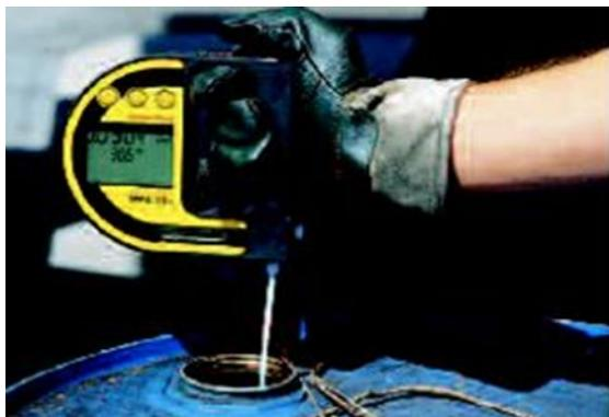
Dichtemessgerät / ©Eichdirektion Nord AÖR
